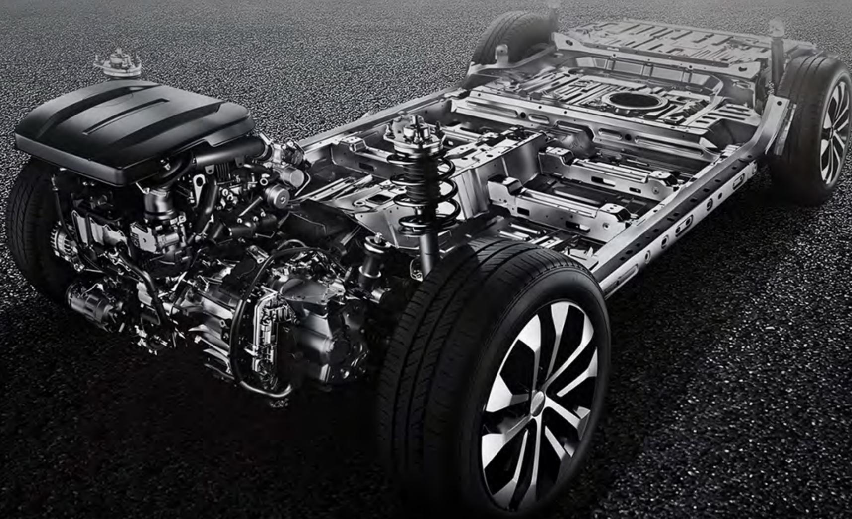
В основе OMODA C5 лежит модульная платформа T1X. Передняя подвеска – независимая McPherson, задняя – полузависимая пружинная, с гидравлическими телескопическими амортизаторами. OMODA C5 выгодно отличается от конкурентов длинной колёсной базой (2630 мм) и внушительным дорожным просветом (190 мм).
